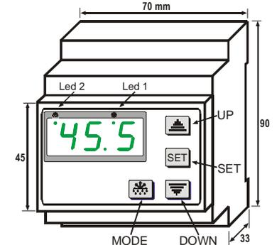
**Up:** 1) Augmenter la valeur du paramètre sélectionné; 2) Faire défiler les paramètres en mode prog; 3) Affichage de la température du collecteur (sonde 2).
